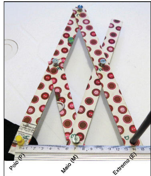
Figura 18 – Pantógrafo artesanal com escala de 1:2
