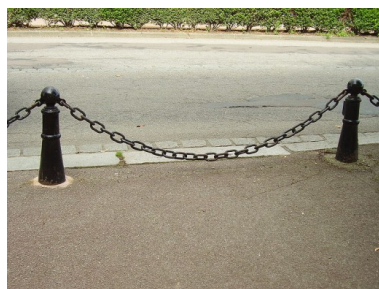
Figura 112 – Catenária formada pela suspensão de uma corrente por dois hastes
