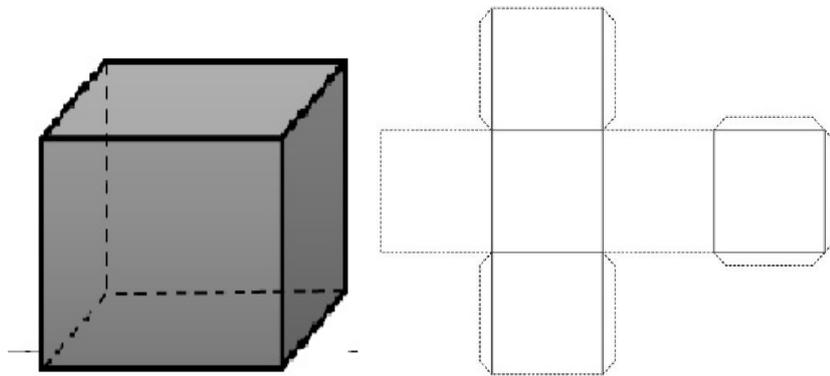
Figura 4.4: Hexaedro (esquerda) e uma representação planificada (direita).
