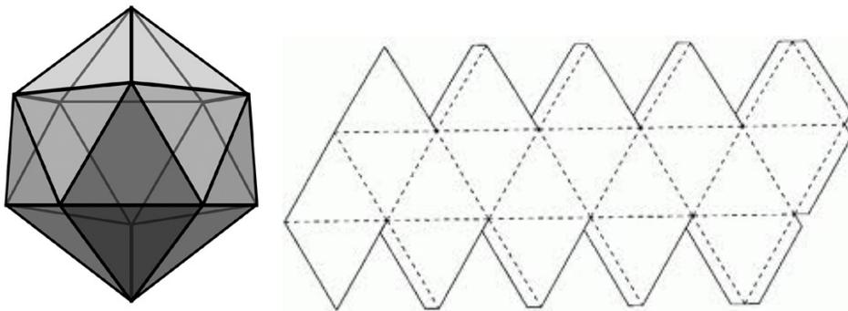
Figura 4.3: Icosaedro (esquerda) e uma representação planificada (direita).
