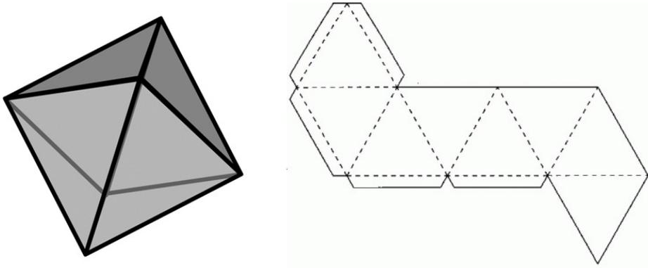
Figura 4.2: Octaedro (esquerda) e uma representação planificada (direita).
