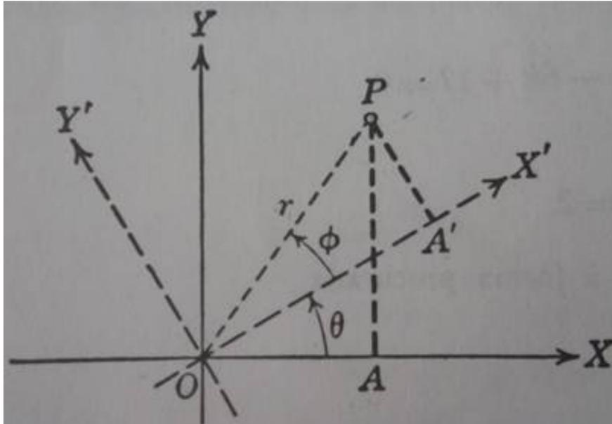
Figura 3.5: Rotação de eixos coordenados
