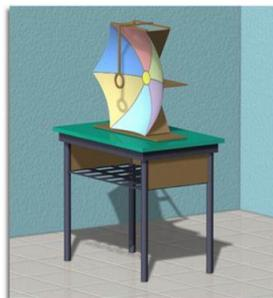
Figura 5.15: Parabofone com armação em madeira
