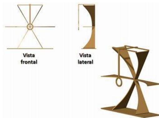
Figura 5.14: Armação para parabofone
