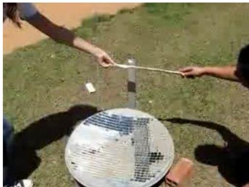
Figura 5.11: Modelo de forno solar
