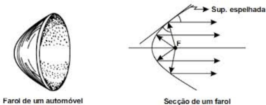
Figura 6.5: Esquema de como funciona o farol
