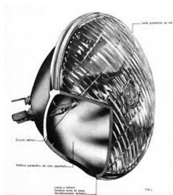
Figura 6.4: Farol de carro com secção lateral
