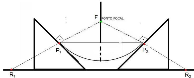
Figura 5.12: Modelo para achar o foco de uma antena parabólica
