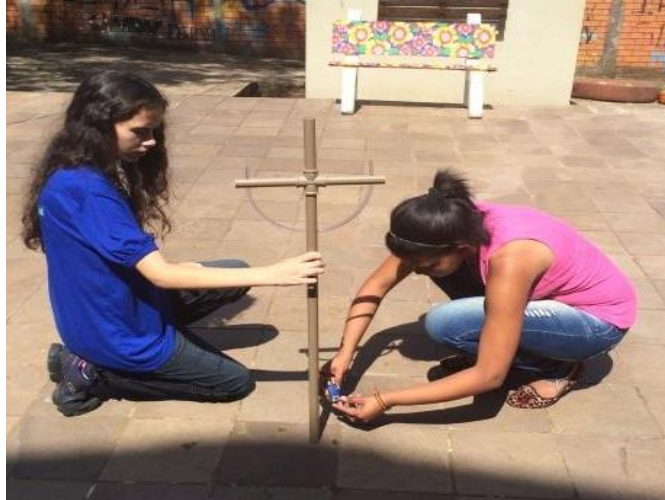
Figura 21 - Prumo e medida da sombra da estaca Fonte: Registro fotográfico do autor, 2015.
