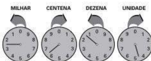
Figura 1 – Medidor de energia elétrica 4
