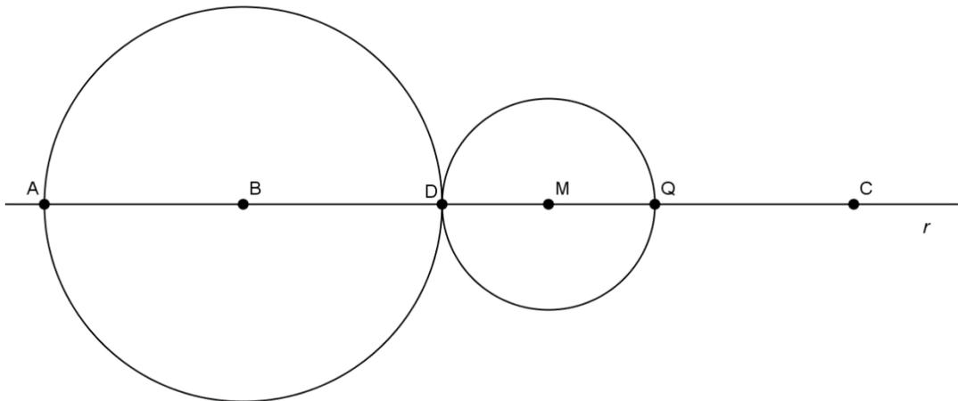
Traçando a circunferência com centro em  $M$  e raio  $|\overline{MD}|$ , obtemos o ponto  $Q$ , interseção da reta  $r$  com a circunferência traçada. Temos que  $\overline{DM}$  e  $\overline{MQ}$  possuem o mesmo comprimento. Assim, os segmentos  $\overline{AQ}$  e  $\overline{BC}$  têm o mesmo comprimento.
