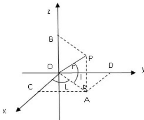
Figura 10: Sistema Ortogonal para cálculos de latitude e longitude de um ponto  $P(x, y, z)$  sobre a superfície da Terra
