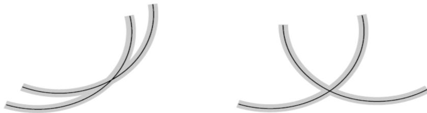
Figura 12: *Um pequeno ângulo de intersecção na parte esquerda (a perda de precisão) e um grande ângulo para a direita .*
