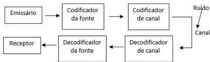
Figura 3.1: Esquema de um canal codificado
