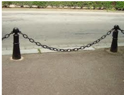
Figura 3.1: Corrente formando uma catenária
