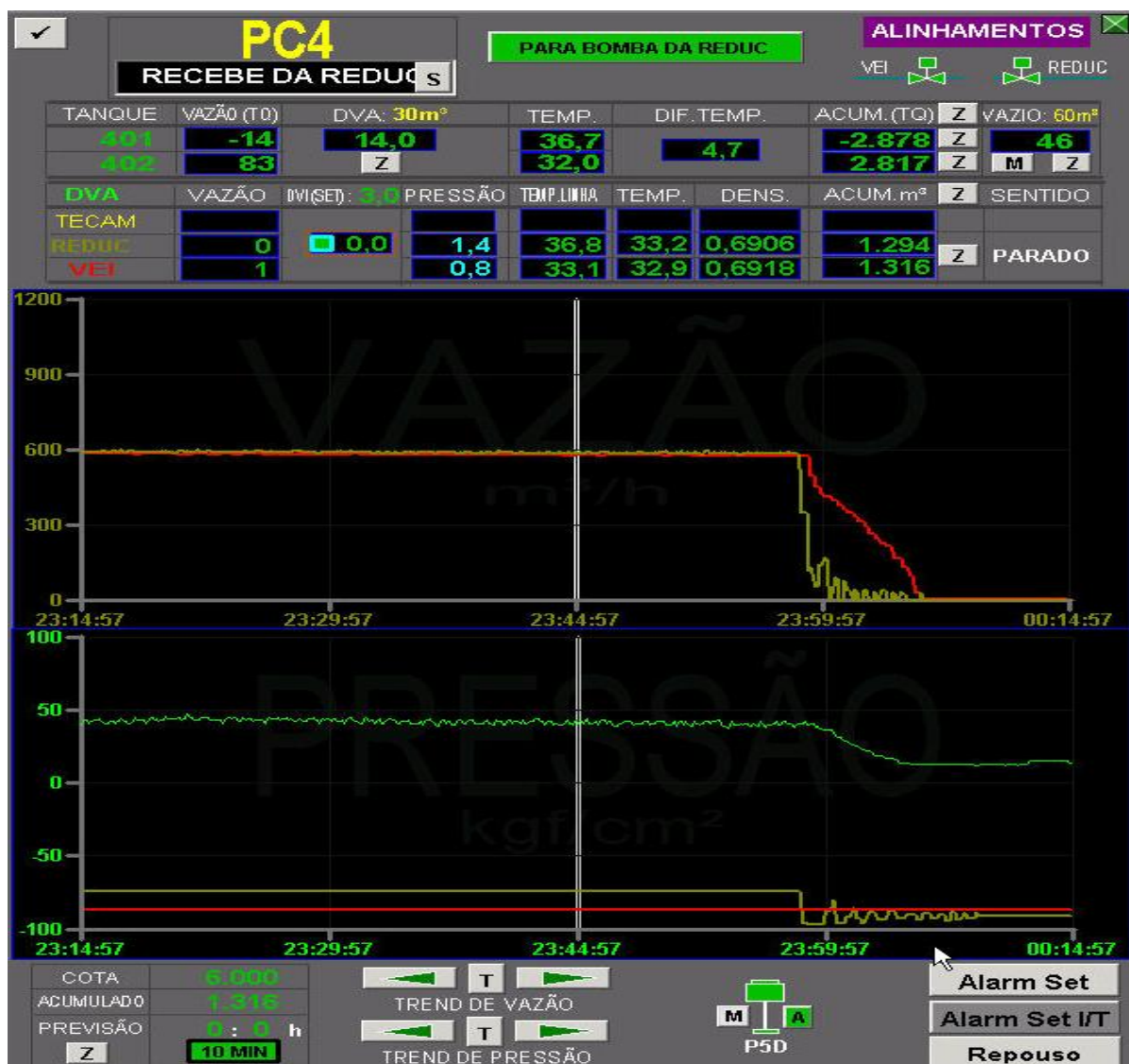
Figura 49 - Monitoramento da transferência da REDUC para ID em término de operação
