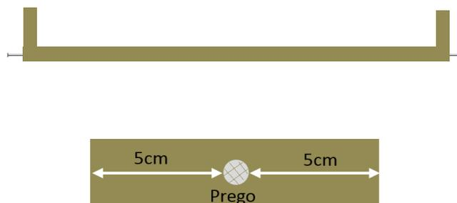
Figura 11 - Esquema lateral e frontal posicionamento pregos
