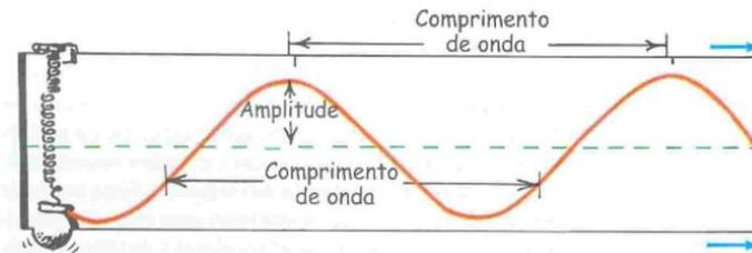
Figura 8 - Esquema: Comprimento e Amplitude de Onda
