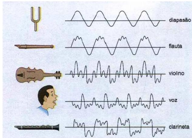
Figura 32 - Formas de ondas correspondentes a alguns instrumentos
