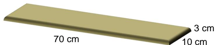
Figura 9 - Especificações da tábua para a construção do monocórdio
