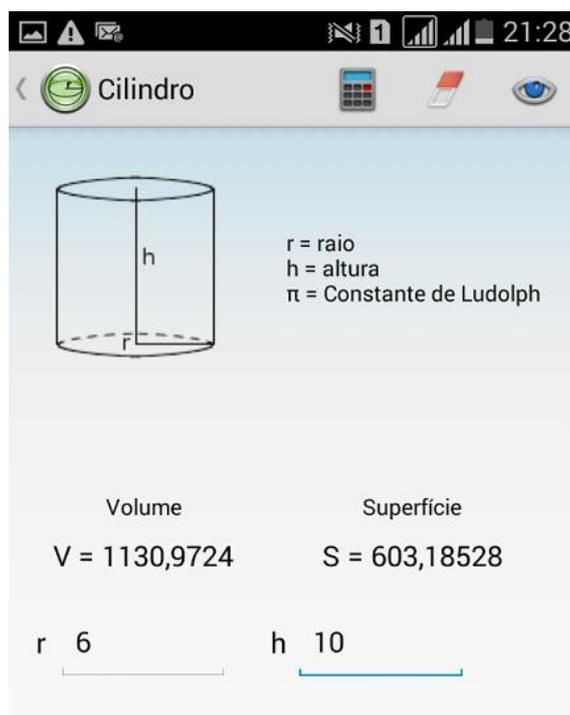
Figura 28: AD 2.2.5 - Cálculo do volume e área total do cilindro.
