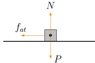
Do diagrama, verificamos que a força normal e a força peso possuem o mesmo módulo ( $N = P$ ), e que a força de atrito atua em sentido contrário ao movimento do corpo no plano horizontal, sendo a única que atua nesse sentido. Portanto, durante a frenagem do carro no plano horizontal, a força de atrito é a resultante das forças do sistema. Daí, pela 2ª Lei de Newton, temos:
