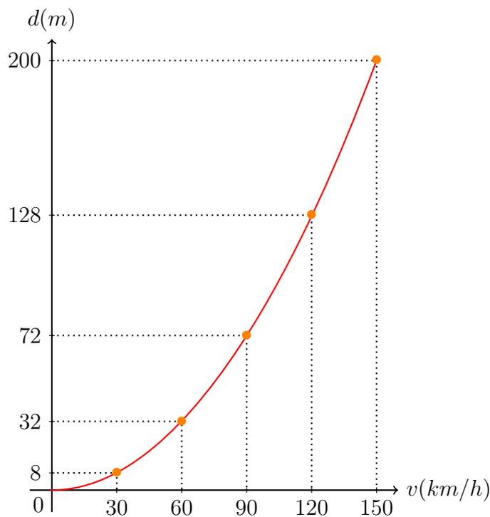
Quando a velocidade duplica, triplica, quadruplica, etc., a distância de frenagem fica multiplicada por 4, 9, 16, etc., o que mostra o perigo da alta velocidade.
