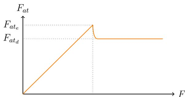
Se o corpo estiver parado sobre o plano horizontal, e não existir movimento do mesmo, não haverá atrito entre o corpo e a superfície de contato, ou seja,  $f_{at} = 0$ . Figura Ilustrativa
