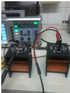
Figura 18: Uma bobina se aproxima da outra e capta seu campo magnético
