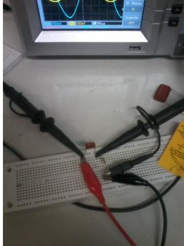
Figura 38: Montagem do Circuito Derivador, um resistor de 1\text{ k}\Omega em série com um capacitor de 0,01\ \mu\text{F} .
