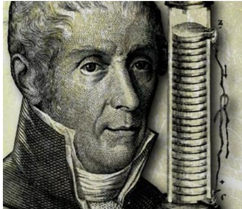
Figura 48: A primeira pilha de 1800, usa-se uma série de discos de zinco e prata, separados por papel cartão embebido em salmoura. ( http://www.brasilecola.com/quimica/alessandro-volta.htm ).
