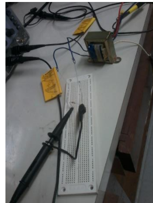
Figura 19: Um transformador 220 V/ 12 V e um resistor de 10 k \Omega é alimentado no secundário.
