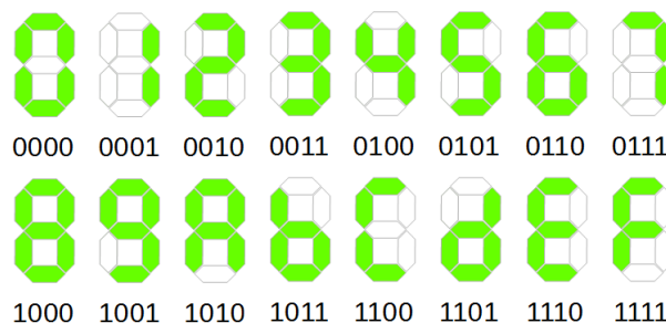
Figura 3.8: Relação entre os binários e a combinação de leds acessa
