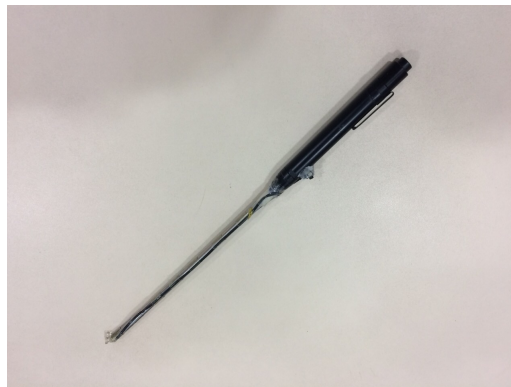
Figura 4.5: Caneta construída com um LED IR.
