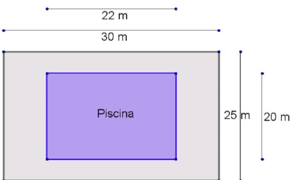
Figura 3.11: Planta baixa da construção de uma piscina.
