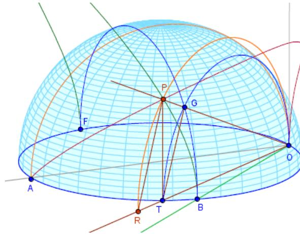
Figura 2.3: Interseção das superfícies de revolução e suas projeções.
