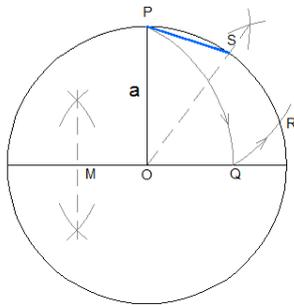
Figura 3.5: Divisão de circunferência em 10 partes com régua e compasso
