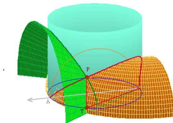
Figura 2.2: Interseção das superfícies de revolução.
