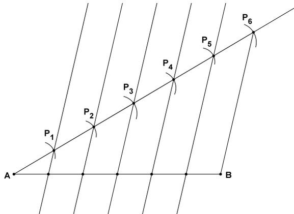
Figura 1.5: Divisão de um segmento em partes iguais.
