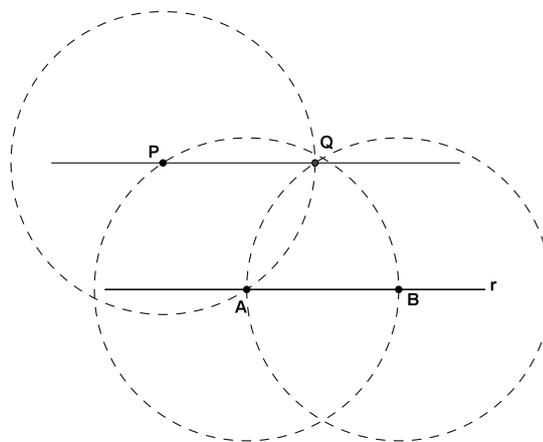
Figura 1.2: Construção de retas paralelas.
