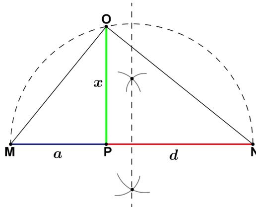
Figura 3.2: Média proporcional entre a diagonal da face e a aresta do cubo (a) da figura 3.1
