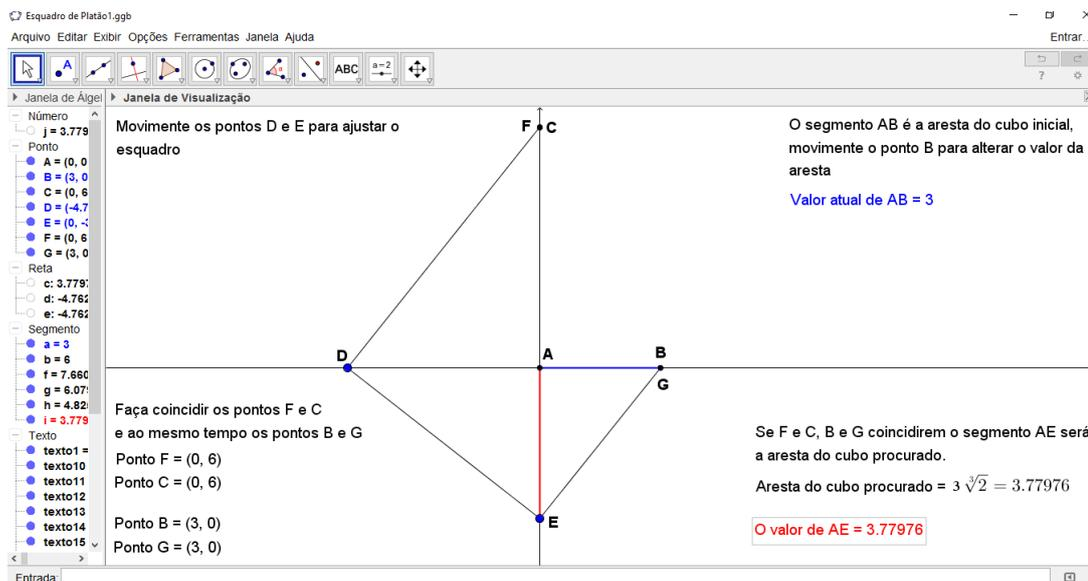
Figura 5.17: Esquadro de Platão devidamente posicionado gerando as proporções desejadas.
