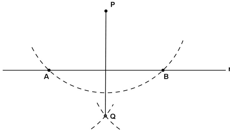
Figura 1.1: Construção de retas perpendiculares.
