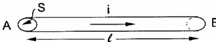
Figura 1 – Um fio com seção  $S$  constante.
