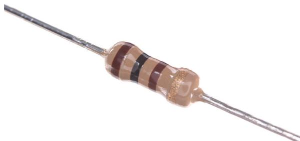
Figura 12 – Um resistor de  $100\ \Omega$ .
