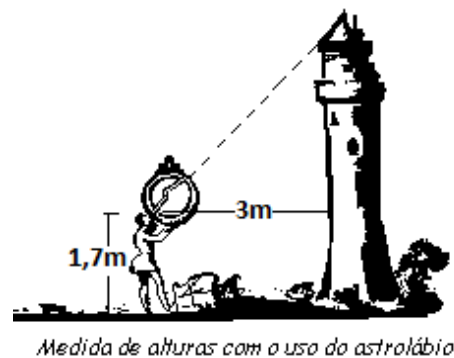
Figura 5. Medir altura com o astrolábio náutico
