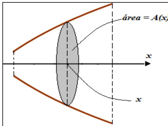
Figura 5: Seção transversal do sólido
