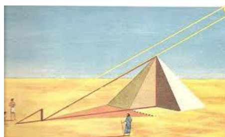
Figura 11: Método para medir a altura da pirâmide
