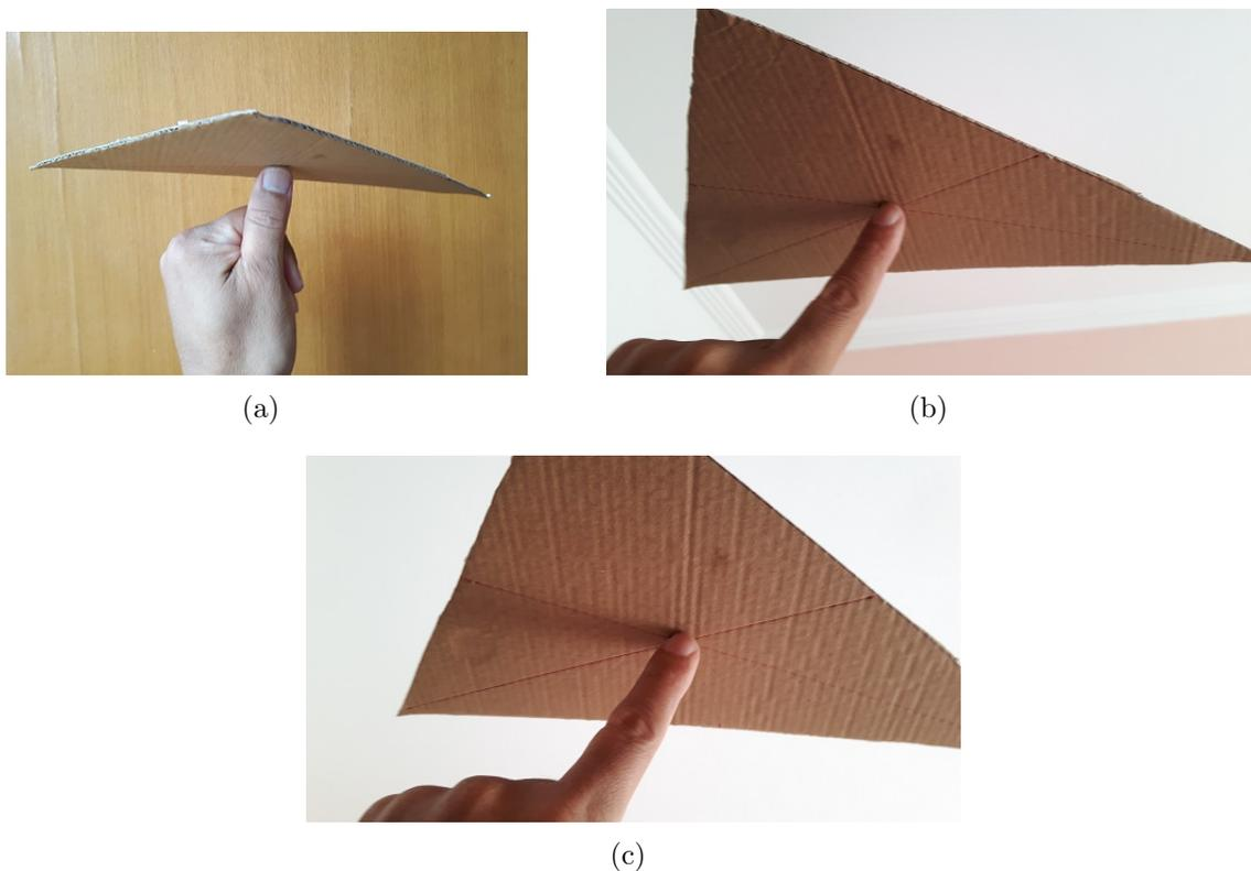
Figura 3.9: Triângulo equilibrado com o dedo pelo ponto do Baricentro do Triângulo
