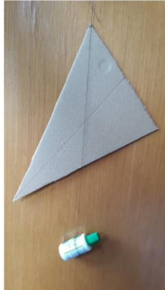
Figura 3.6: Traçando o 2º segmento de reta que contém o Baricentro do Triângulo
