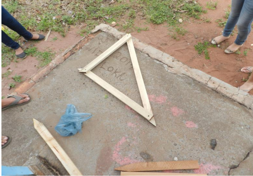
Figura 4.5: Esquadro de madeira construído pelos alunos.
