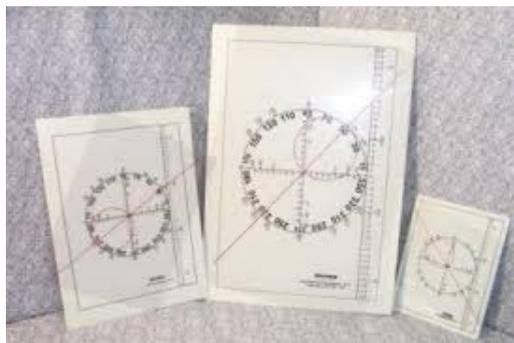
Figura 5.5: Prancha Trigonométrica
