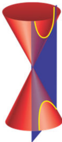
Figura 33: Obtenção da hipérbole por secção cônica
