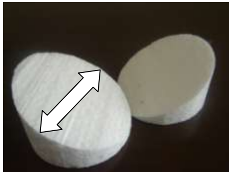
Figura 40 Secção transversal é uma elipse. Qualquer que seja o ângulo do corte, a distância entre dois vértices de um de seus eixos se mantém constante e igual ao diâmetro do cilindro
