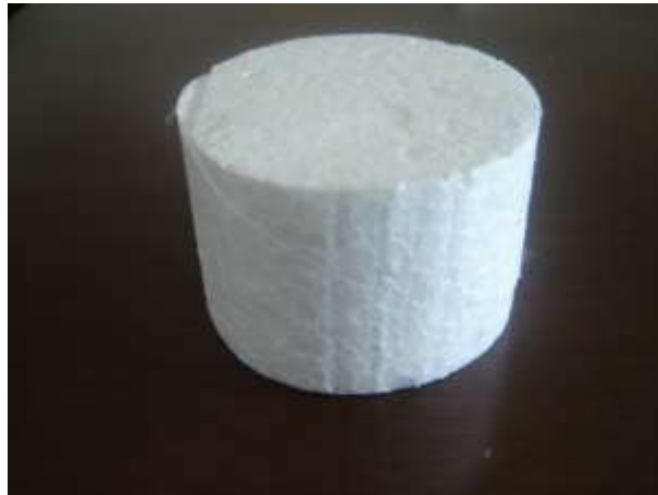
Figura 39 Um cilindro que foi partido transversalmente com o uso de esquadro
