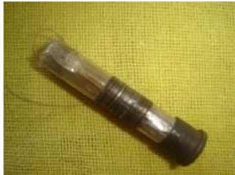
Figura 4 Resistência elétrica retirada do aparelho da figura anterior e utilizado como fio de corte da mesa. Bastante fino, proporciona cortes precisos
