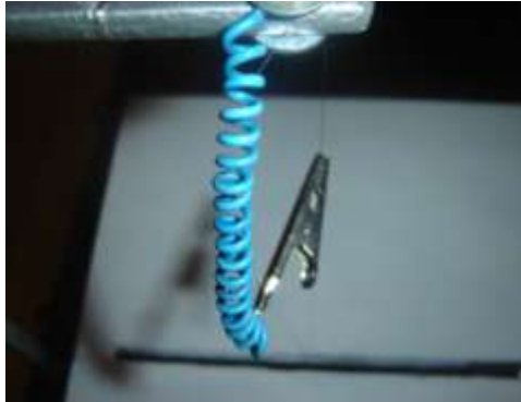
Figura 8 Detalhe da parte superior do aparelho. O conector jacaré isola parte da resistência e aumenta a potência da máquina ao deslizar para baixo
