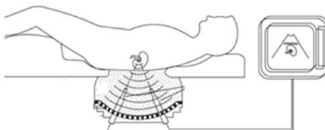
Figura 57: Ondas geradas por um Litotriptor para pulverização de cálculo renal - Fonte referência [5].
