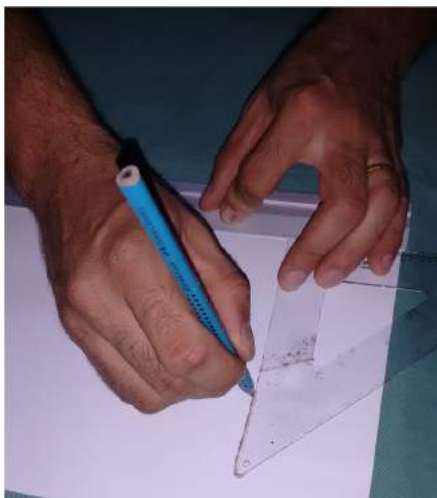
Figura 45: Posicionamento do lápis sobre o esquadro para construção da parábola.
