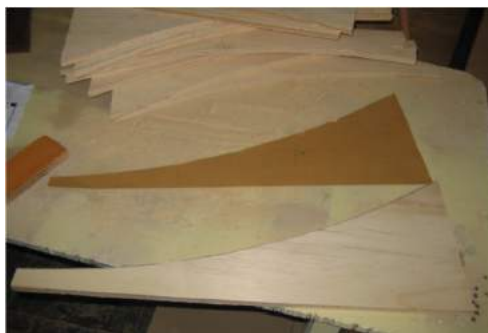
Figura 82: Molde e peças de sustentação recortados conforme dados da tabela – Fonte referência [29].
