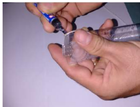
Figura 24: Colagem da extremidade do barbante na extremidade oposta ao furo da régua.
