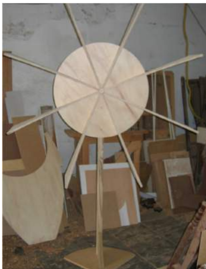
Figura 87: Refletor acústico parcialmente montado – Fonte referência [29].
