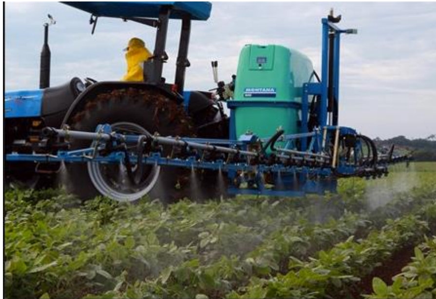
Figura 3.7: Pulverizador hidráulico. Obtida em http://www.cnpma.embrapa.br e modificada pelo autor.
