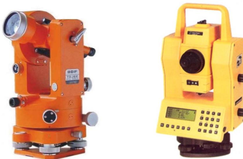
*Figura 1.6 - Teodolito mecânico e eletrônico com visor de ângulos com display.*
