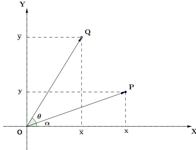
Com a rotação do vetor  $\overrightarrow{OP}$  de um ângulo  $\theta$  temos que  $\cos(\theta + \alpha) = \frac{\bar{x}}{\sqrt{x^2 + y^2}}$  pois a distância de  $O$  até  $P$  é a mesma distância de  $O$  até  $Q$ . Analogamente  $\text{sen}(\theta + \alpha) = \frac{\bar{y}}{\sqrt{x^2 + y^2}}$ .
