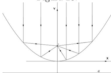
Justificaremos agora a razão pela qual as ondas paralelas ao eixo quando tocam a parábola incidem no foco.
