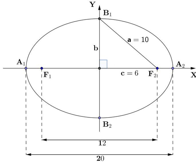
Note que se no enunciado do exemplo anterior tivéssemos o eixo maior sobre o eixo das ordenadas e distância focal de medida 12 teríamos a equação  $\frac{x^2}{64} + \frac{y^2}{100} = 1$ .
