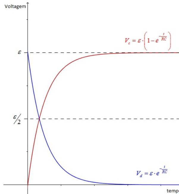
Figura 4.4: Gráfico de  $V \times t$  em um circuito RC - carregamento e descarregamento - imagem produzida pelo autor.
