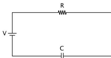
Figura 4.3: Representação de um circuito RC (confeccionado por meio do simulador online circuits, disponível em <http://www.falstad.com/circuit/>).
