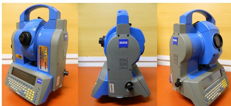
Figura 8 – Estação Total robotizada.
