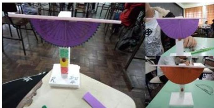
Figura 30 – Teodolitos construídos pelos alunos.
