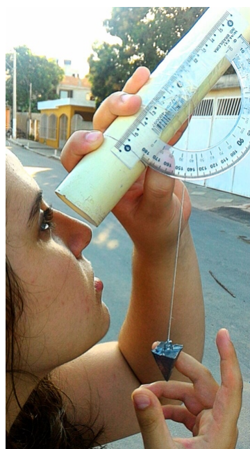
Figura 80 – Teodolito Apontado para o Topo do Prédio
