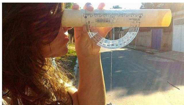
Figura 79 – Teodolito Apontado para o Prédio
