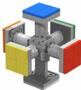
Figura 2.2: Mecanismo interno de um cubo mágico 3 \times 3 \times 3 .
