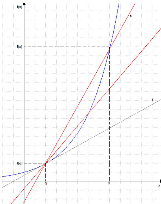
Isto mostra que, geometricamente a derivada de  $f$  no ponto  $q$  representa o coeficiente angular da reta tangente ao gráfico de  $f$  no ponto  $(q, (f(q)))$ .
