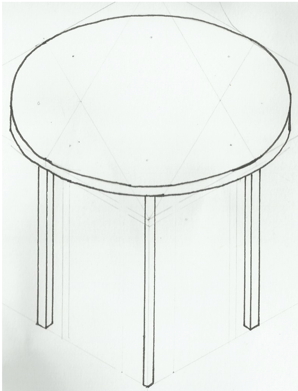
Mesa circular na escala 1:7,5 - Vista isométrica
