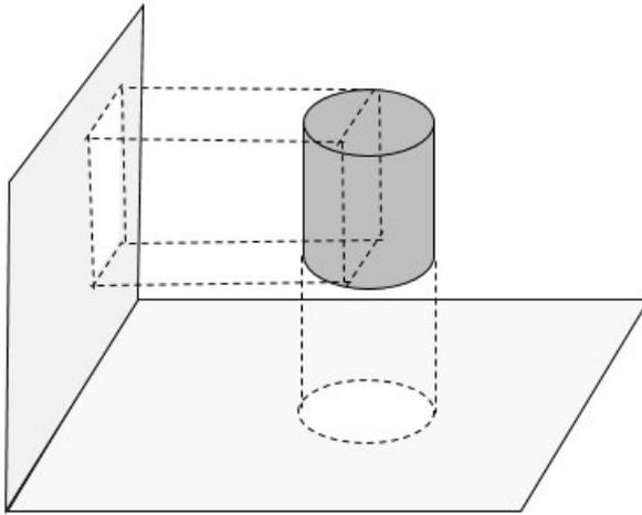
Na figura ao lado, a projeção ortogonal do cilindro em relação ao plano horizontal é um círculo de mesma medida que o círculo da base do cilindro e a projeção ortogonal em relação ao plano vertical é um retângulo de mesma medida que a seção meridiana do cilindro.
