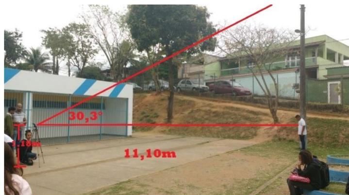
Figura 14 – Valores básicos para calcular a altura do poste.
