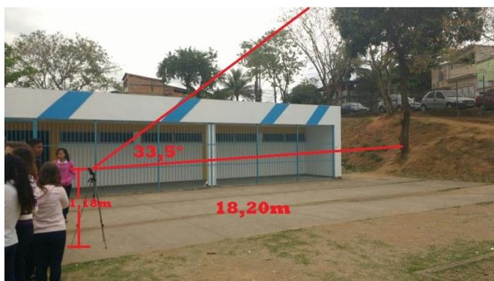
Figura 15 – Valores básicos para calcular a altura da árvore.
