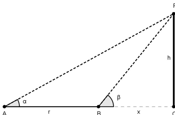
Figura 7 – Altura inacessível.
