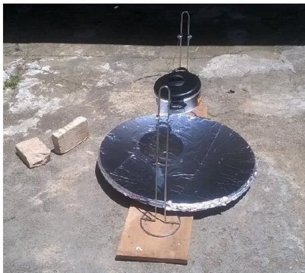
Figura 2.31: Ajustando a antena conforme a posição do Sol (Meio dia).
