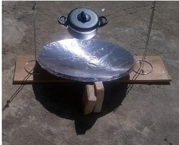
Figura 2.30: Ajustando a antena conforme a posição do Sol (Antes do meio dia).
