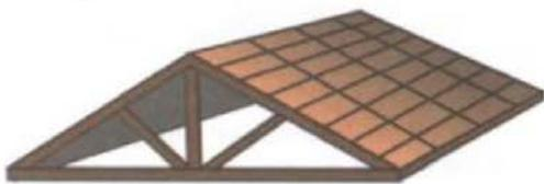
Madeiramento do telhado ou "tesoura"
