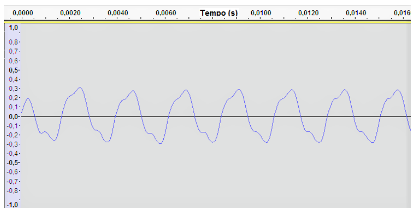
Figura 40 – Ondas sonoras do Sax Tenor emitindo a nota Lá ( 440\text{Hz} ) capturadas pelo software Audacity
