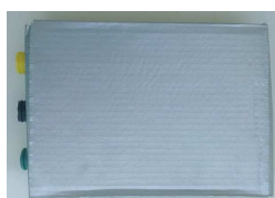
Figura 3.15 – Caixa fechada pintada com spray prata
