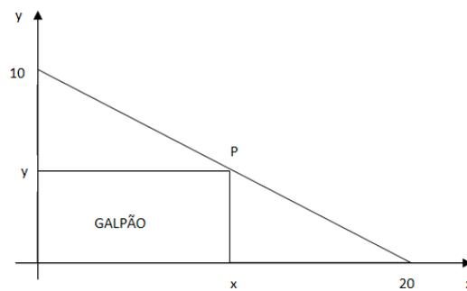
Figura 19 – Plano cartesiano e variáveis utilizados no cálculo do terreno de área máxima
