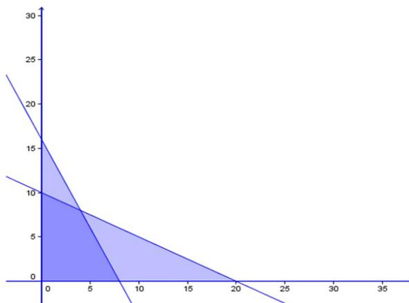
Figura 26 – Intersecção entre as restrições 1 e 2,  $3x + 6y \leq 60 \cap 4x + 2y \leq 32$
