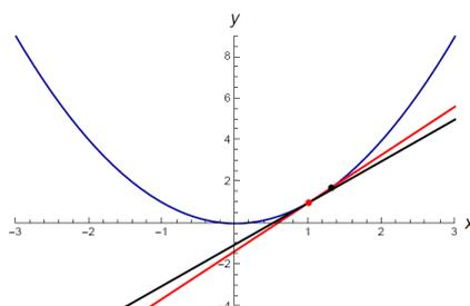
Figura 7 – Aproximação da reta tangente por retas secantes, com pontos P e Q bem próximos.
