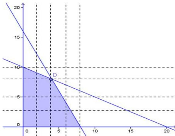
Figura 27 – Região factível e retas paralelas aos eixos coordenados
