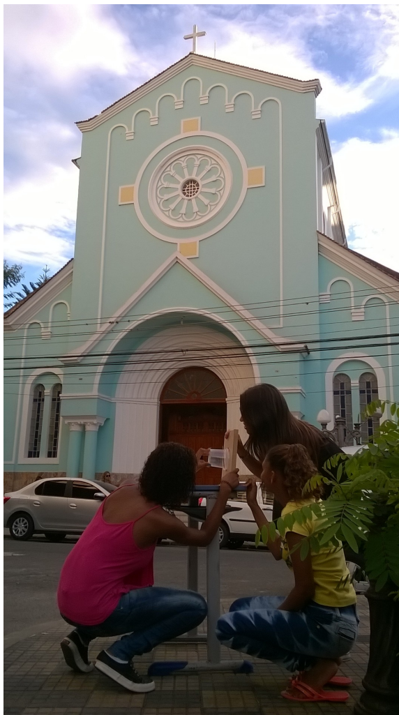
Figura 33 – Medindo a que altura do chão está a cruz da igreja utilizando o Teodolito
