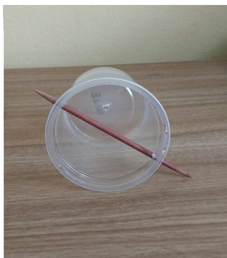
Figura 26 – Ponteiro de leitura do Teodolito
