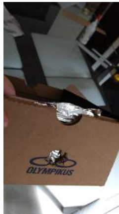
Figura 3.46: Papel alumínio na parede com abertura
