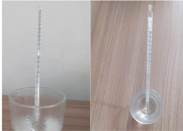
Figura 4.64: Experimento Lei de Resfriamento de Newton
