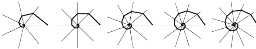
Figura 10: Processo de construção da espiral
