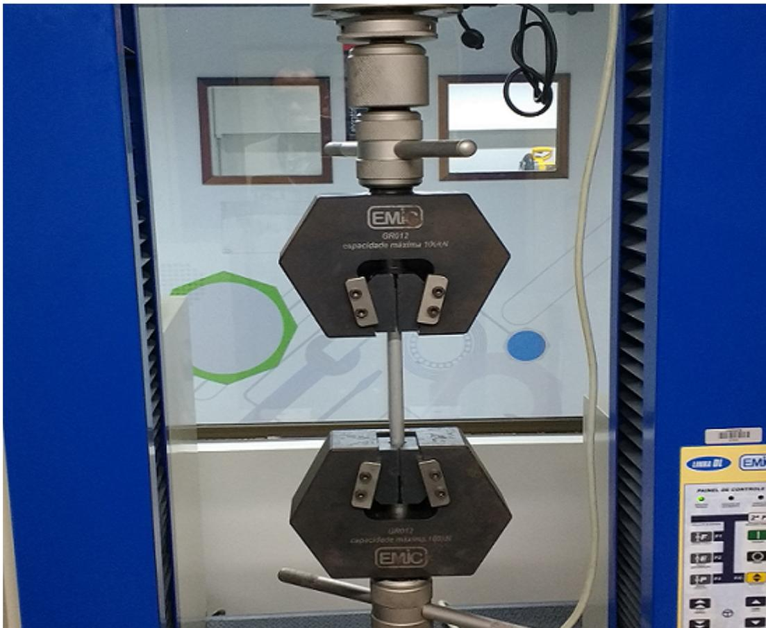
Figura 3.1: Máquina universal de ensaio de tração - Marca EMIC, modelo DL 3000
